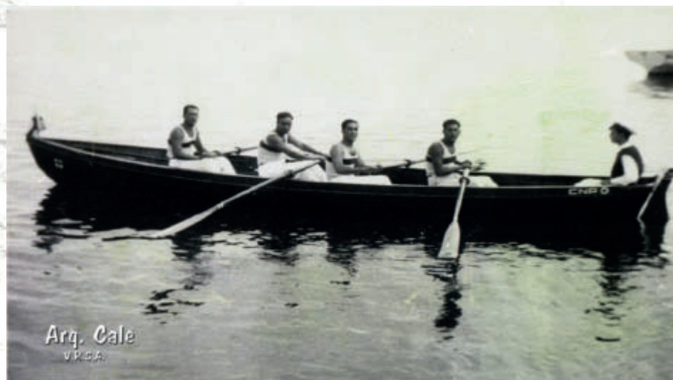
Escaler de aproximadamente 22 pés e uma boca de 1,30 m, calando 20 cm de água, e pontal de 0,50 com. Visíveis as iniciais do Clube Náutico de Portugal.
